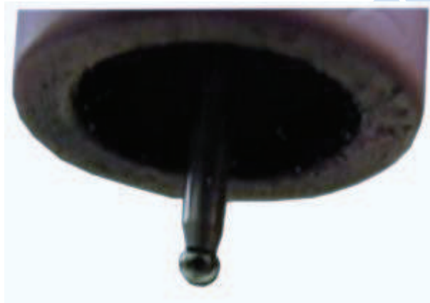
Rys. 43 Elektroda nietopliwa po procesie zaokrąglania
