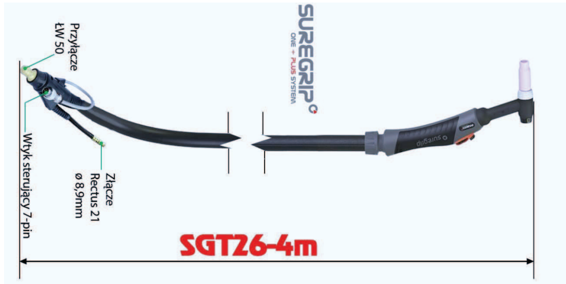
Rys. 19 Uchwyt TIG 26, chłodzony gazem - schemat
