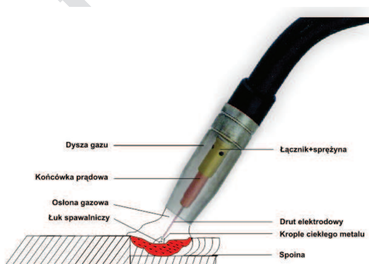
Rys 4. Spawanie MIG/MAG - schemat
