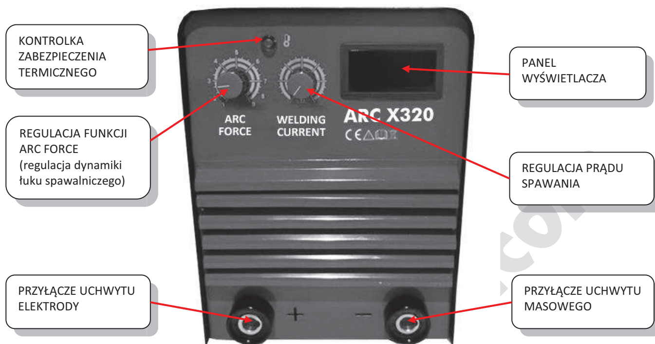
Opis panelu przedniego dla modelu ADORE ARC X320.
